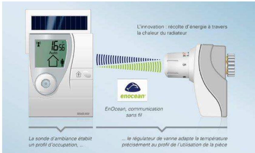
d'Énergie Harvesting. Le capteur récolte son énergie via un module solaire combiné à un accumulateur d'énergie interne. Le régulateur de vanne est alimenté par un thermo-générateur intégré qui transforme la chaleur du radiateur en énergie électrique.
